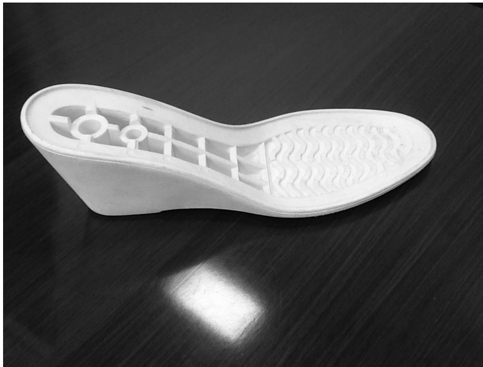
Aligeramiento típico de suela con tacón alto
